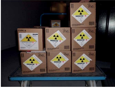
Bultos de transporte Tipo A. (Fuente. Elaboración propia).
